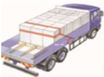
25 pav. Spyruoklinis pririšimas naudojant specialų diržą
