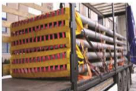
21 pav. Tvirtinimas tinklu ir tiesioginis pririšimas priekine kryptimi
