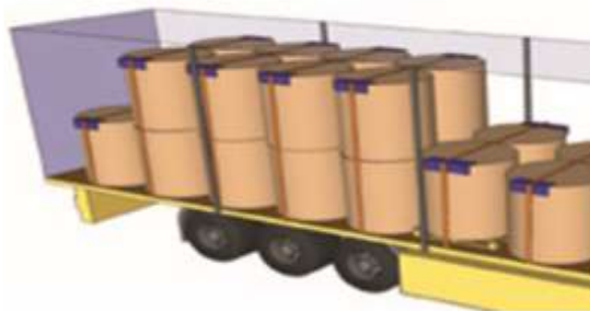
24 pav. Blokavimas plokštėmis naudojant krovinio padėklą
